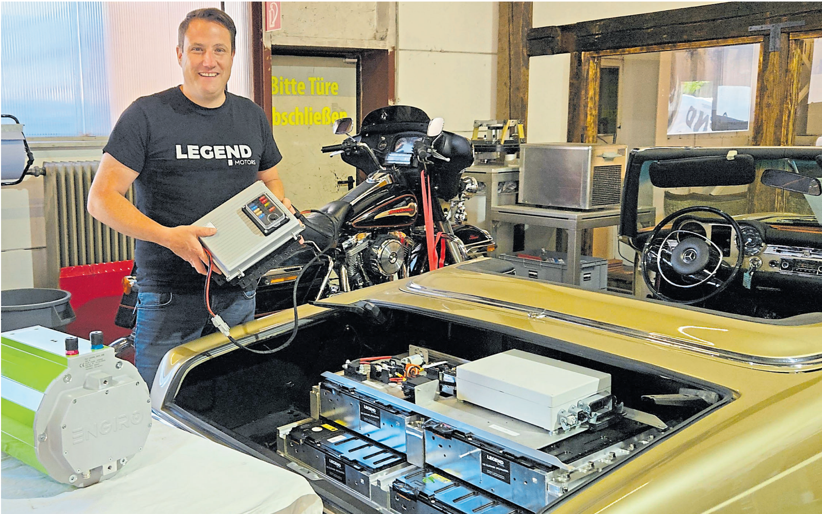
Ein Kofferraum voll Power: In dem Mercedes Pagode sind die Batterien für den Antrieb dort untergebracht, wo sonst das Gepäck verstaut wird. Clemens Hummel hält die elektronische Steuereinheit. Auf dem Tisch liegt der grüne Elektromotor, der nur etwa ein Drittel so groß ist wie der Verbrenner. Fotos: HWK KN/Julia Kipping
