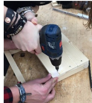
Arbeitsschritt 5: Vorbohren und Verschrauben der ein- zelnen Bodenteile
